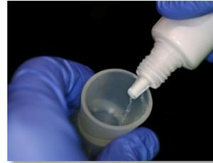
6. Pour la réalisation du crochet esthétique blanc ou transparent, préparer un mélange monomère-polymère approprié de manière à obtenir un produit crémeux qui ne coule pas lorsqu'on le déposera dans l'empreinte silicone du crochet.
