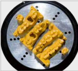
Modèles imprimés en 3D avec de la résine VarseoWax Model
